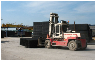
Transbordement des treillis-soudés vers l'aire de stockage. Phot. Clarisse Lorieux IVR22_20076005273NUCA
