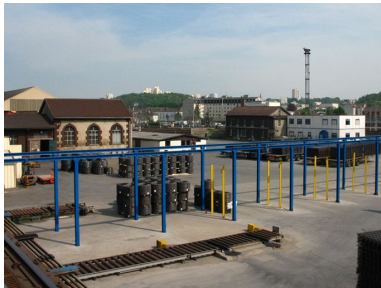
Tapis roulant sortant des ateliers de fabrication de treillis-soudés. Phot. Clarisse Lorieux IVR22_20076005272NUCA
